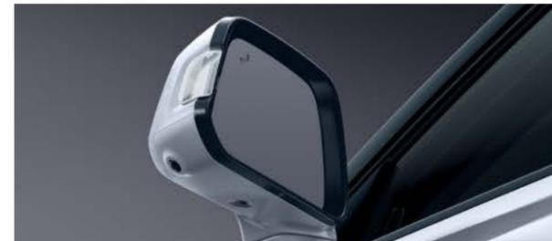
Espejos laterales con ajuste eléctrico, calefactable con luces direccionales LED / plegables eléctricamente
